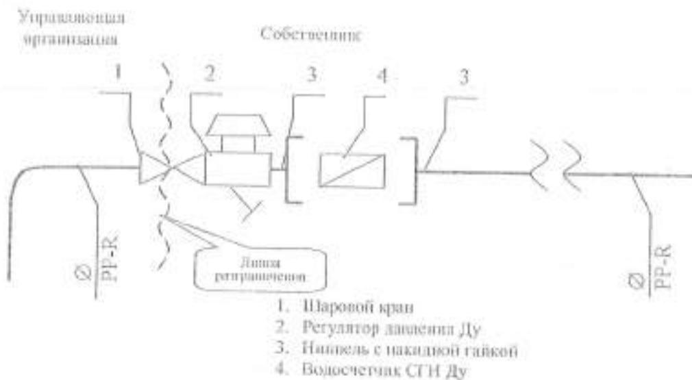
Исполнитель несет ответственность за надлежащее состояние и работоспособность систем горячего и холодного водоснабжения согласно инструкционной схеме до волнистой линии слева (исключая первую группу).
