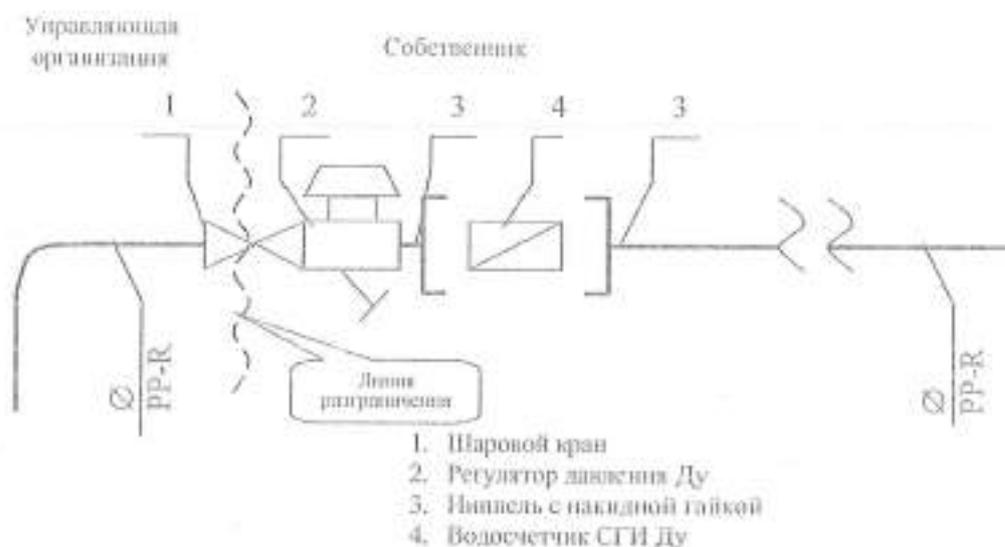
Исполнитель несет ответственность за надлежащее состояние и работоспособность систем горячего и холодного водоснабжения согласно нижеуказанной схеме до впадения линии слева (включая шаровый кран).
