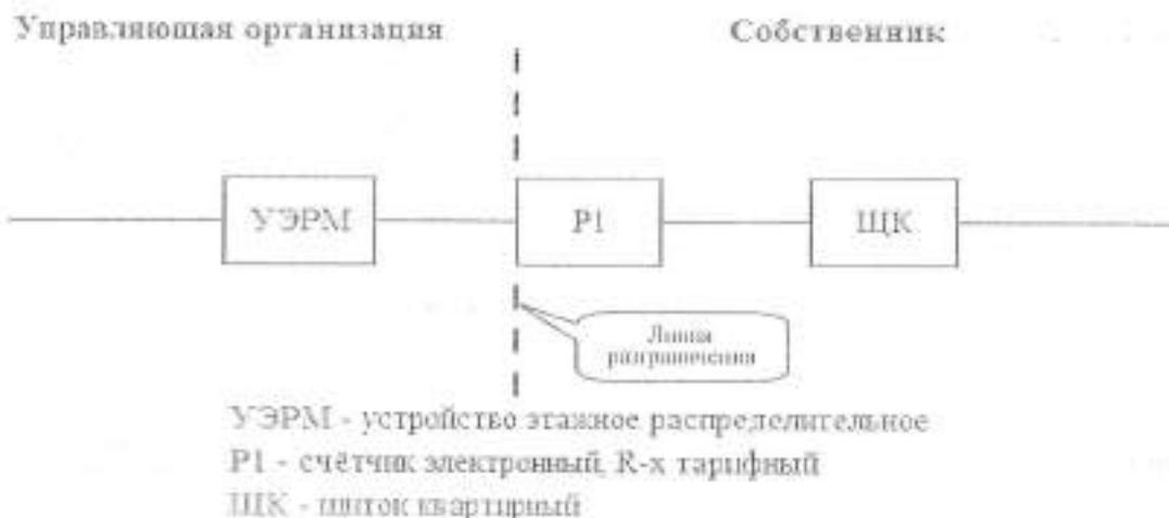
Исполнитель несет ответственность за надлежащее состояние и работоспособность питающих электрических сетей на квартиру согласно нижеуказанной схеме до прибора учета (прибор учета слева).
