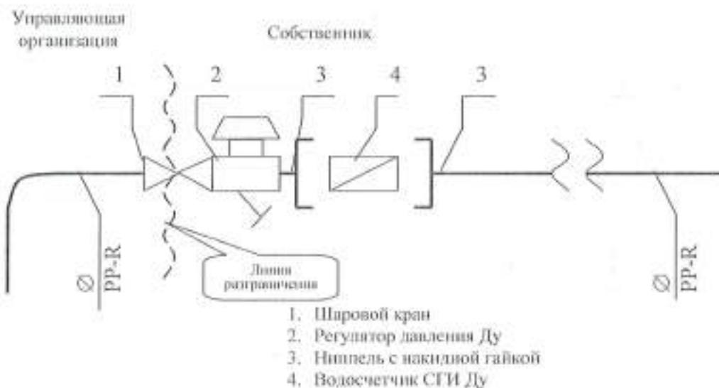
Исполнитель несет ответственность за надлежащее состояние и работоспособность систем горячего и холодного водоснабжения согласно нижеуказанной схеме до волновой линии слева (включая шаровой кран).
