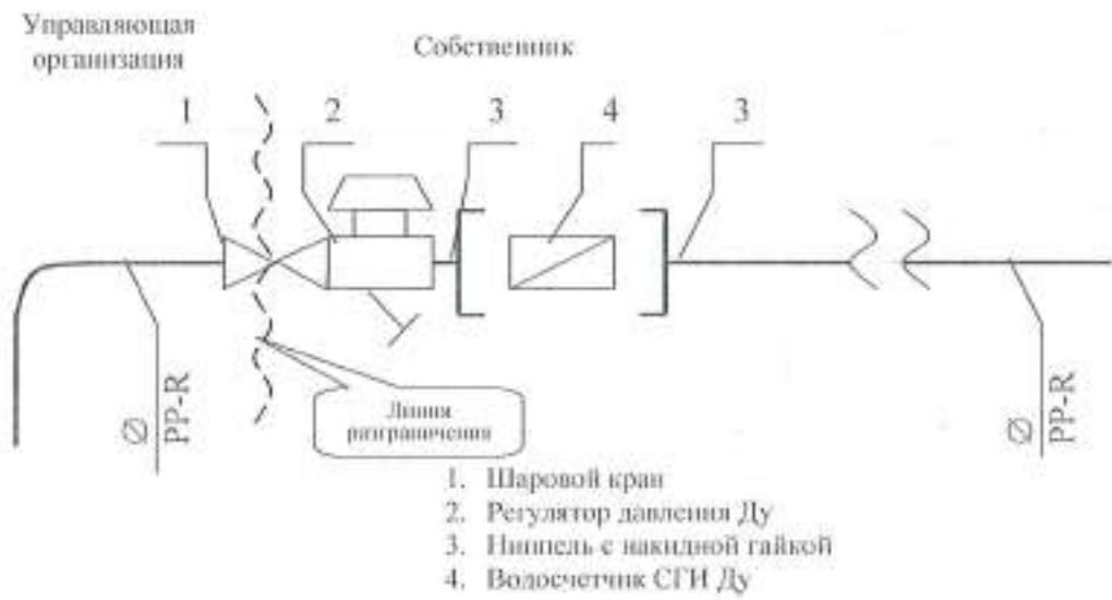
Исполнитель несет ответственность за надлежащее состояние и работоспособность систем горячего и холодного водоснабжения согласно нижеуказанный схеме до волновой линии слева (включая шаровой кран).
