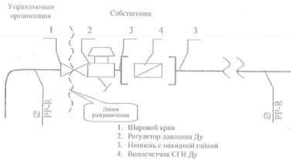
Исполнитель несет ответственность за надлежащее состояние и работоспособность систем горячего и холодного водоснабжения согласно нижеуказанной схеме до волнистой линии слева (включая широкой край).
