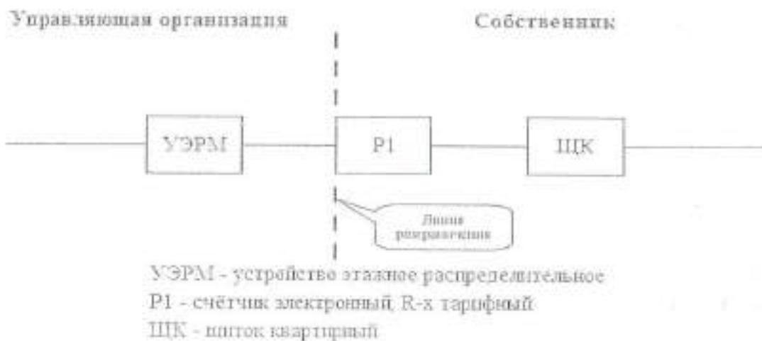
Исполнитель несет ответственность за надлежащее состояние и работоспособность питающих электрических сетей на квартиру согласно нижеуказанной схеме до прибора учета электроэнергии (включая счётчик).
