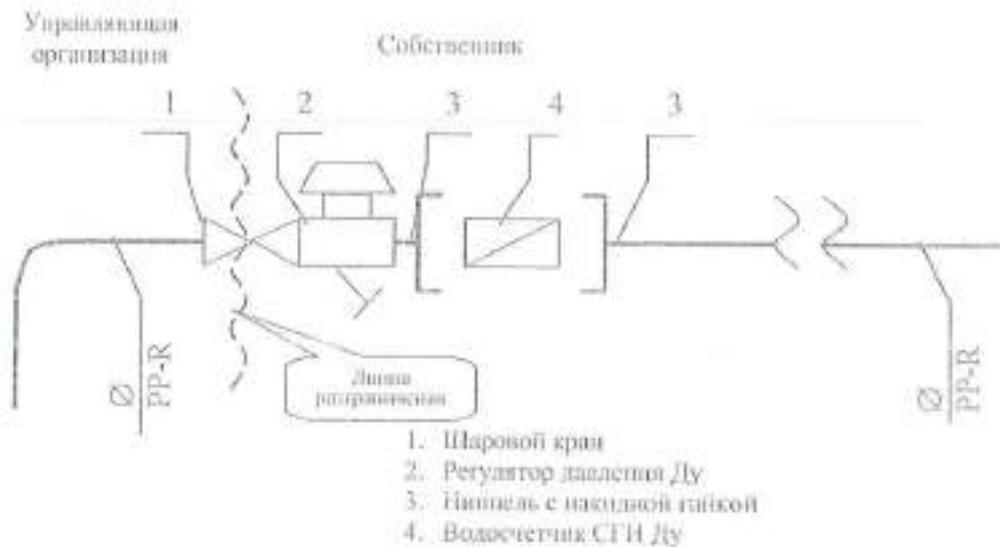
Исполнитель несет ответственность за надлежащее состояние и работоспособность систем горячего и холодного водоснабжения согласно нижеуказанной схеме до полной линии слева (включая шаровой кран).
