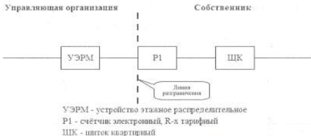
Исполнитель несет ответственность за надлежащее состояние и работоспособность питающих электрических сетей на квартиру согласно нижеуказанной схеме до прибора учета (прямойной линии слева).
