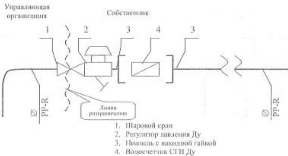
Исполнитель несет ответственность за надлежащее состояние и работоспособность систем горячего и холодного водоснабжения согласно вышеуказанной схеме до полинистой линии слева (включая шаровой кран).
