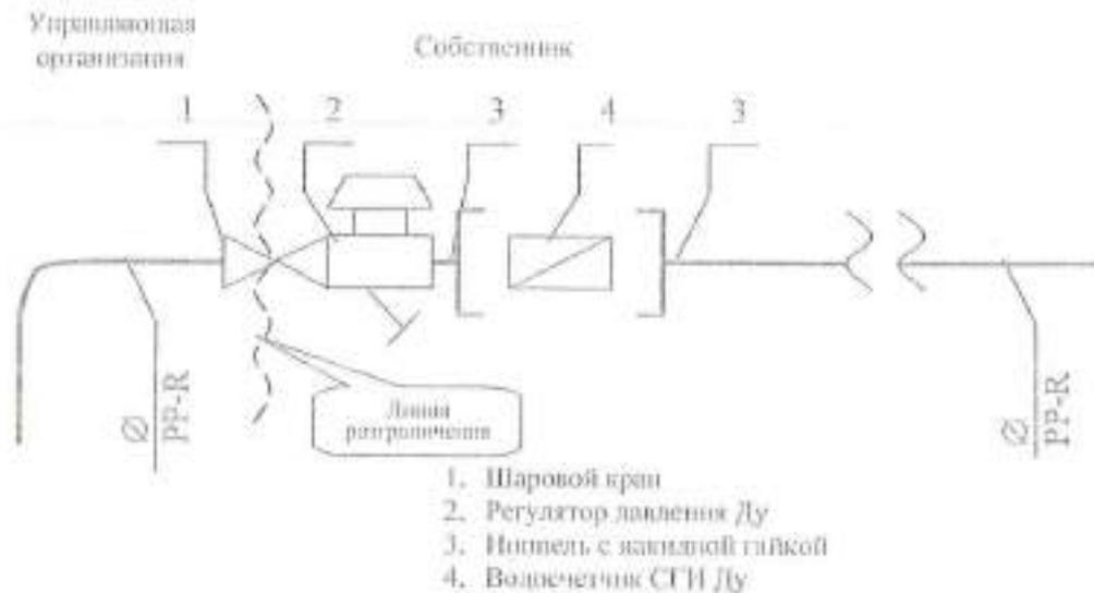
Исполнитель несет ответственность за надлежащее состояние и работоспособность систем горячего и холодного водоснабжения согласно нижеуказанной схеме до волнистой линии слева (включая шаровый кран).
