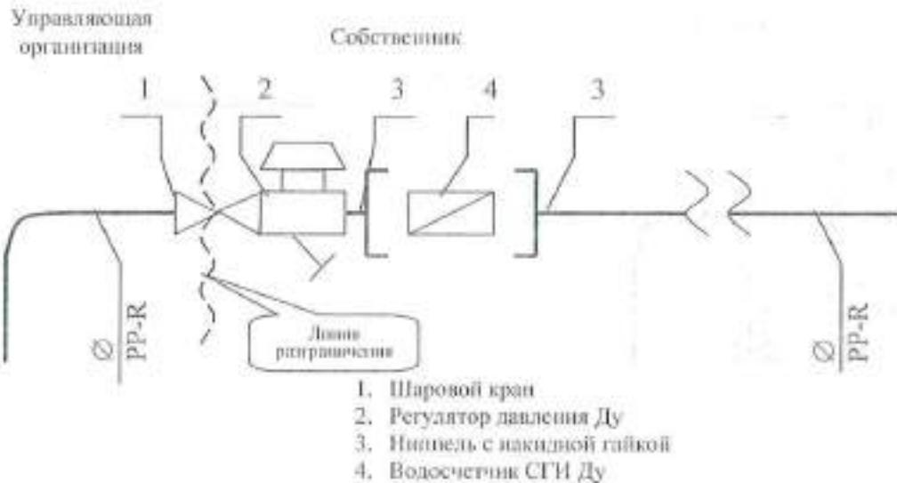
Исполнитель несет ответственность за надлежащее состояние и работоспособность систем горячего и холодного водоснабжения согласно вышеуказанной схеме до волновой линии слева (включая шаровой кран).
