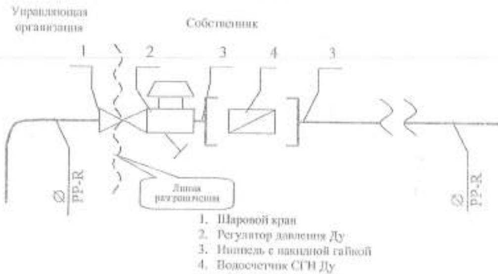
Исполнитель несет ответственность за надлежащее состояние и работоспособность систем горячего и холодного водоснабжения согласно вышеуказанной схеме до границы линии слева (включая шаровой кран).
