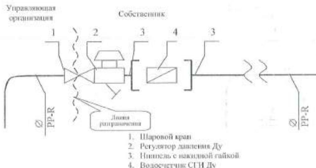
Исполнитель несет ответственность за надлежащее состояние и работоспособность систем горячего и холодного водоснабжения согласно нижеуказанной схеме до волнистой линии слева (включая шаровый кран).
