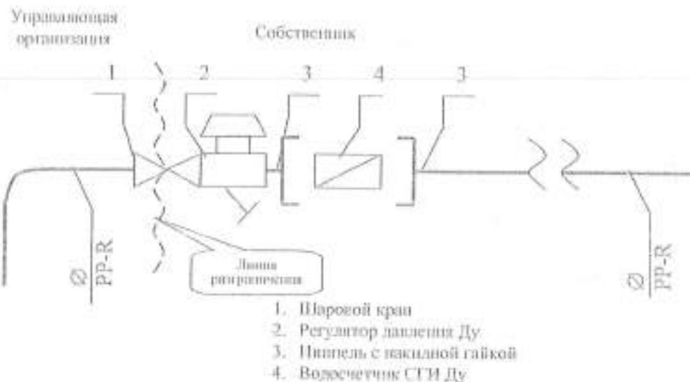
Исполнитель несет ответственность за надлежащее состояние и работоспособность систем горячего и горячего водоснабжения согласно вышеуказанной схеме до волнистой линии слова (включая шаровой кран).
