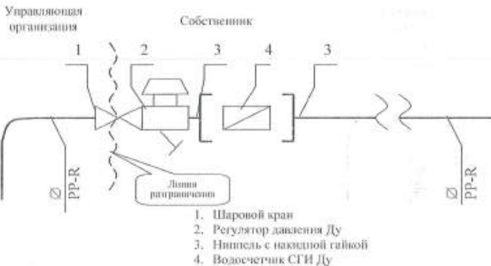
Исполнитель несет ответственность за надлежащее состояние и работоспособность систем горячего и холодного водоснабжения согласно нижеследующей схеме до волнистой линии слева (включая шаровой кран).
