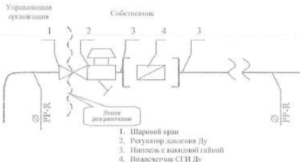
Исполнитель несет ответственность за надлежащее состояние и работоспособность систем горячего и ходоудерживающего волоконирования согласно инструкционной схеме до волнистой линии связи (включая шаровой кран).
