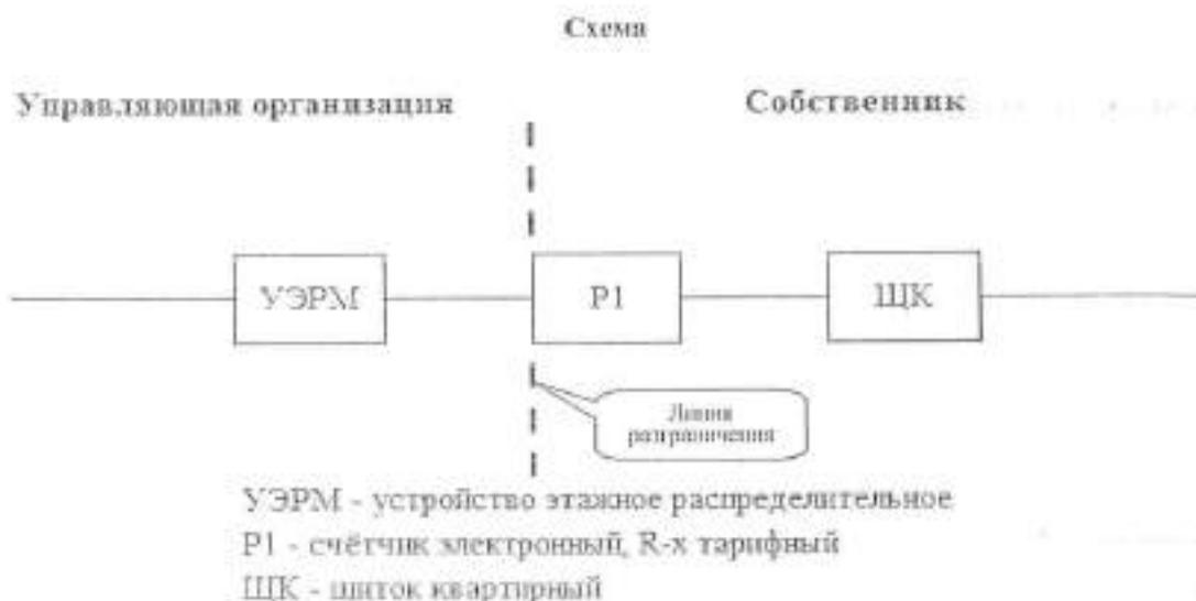
Исполнитель несет ответственность за надлежащее состояние и работоспособность питающих электрических сетей на квартиру согласно нижеуказанной схеме до прибора учета (объект левой линии слева).
