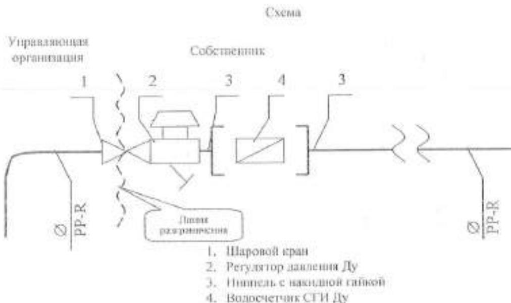
Исполнитель несет ответственность за надлежащее состояние и работоспособность систем горячего и холодного водоснабжения согласно нижеуказанной схеме до возникшей линии слева (включая шаровой кран).
