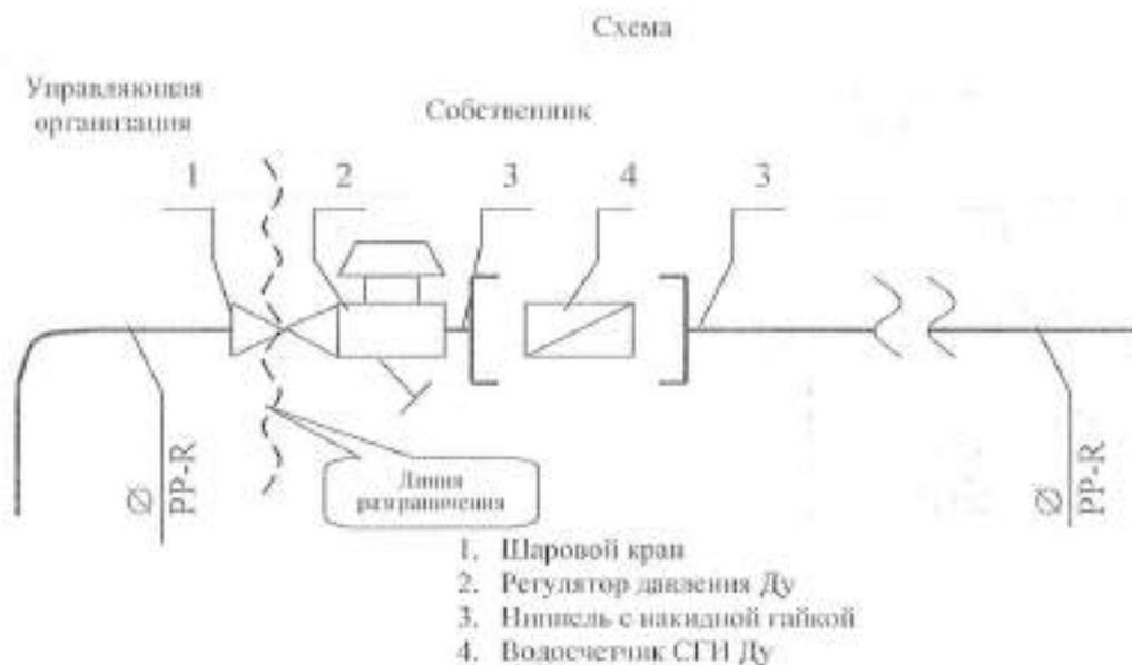
Исполнитель несет ответственность за надлежащее состояние и работоспособность систем горячего и холодного водоснабжения согласно нижеуказанной схеме до волнистой линии слева (включая шаровый кран).
