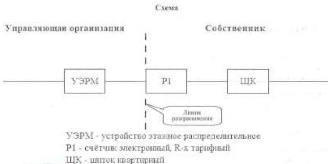
Исполнитель несет ответственность за надлежащее состояние и работоспособность питающих электрических сетей на квартиру согласно нижеуказанной схеме до прибора учета (границей линии слева).
