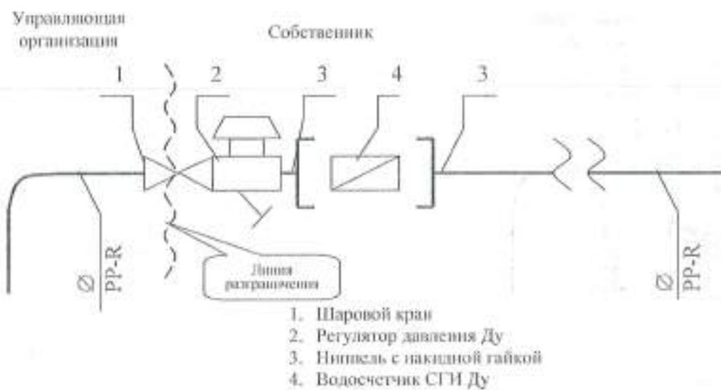
Исполнитель несет ответственность за надлежащее состояние и работоспособность систем горячего и холодного водоснабжения согласно нижеуказанный схеме до водопроводной линии слева (включая шаровой кран).
