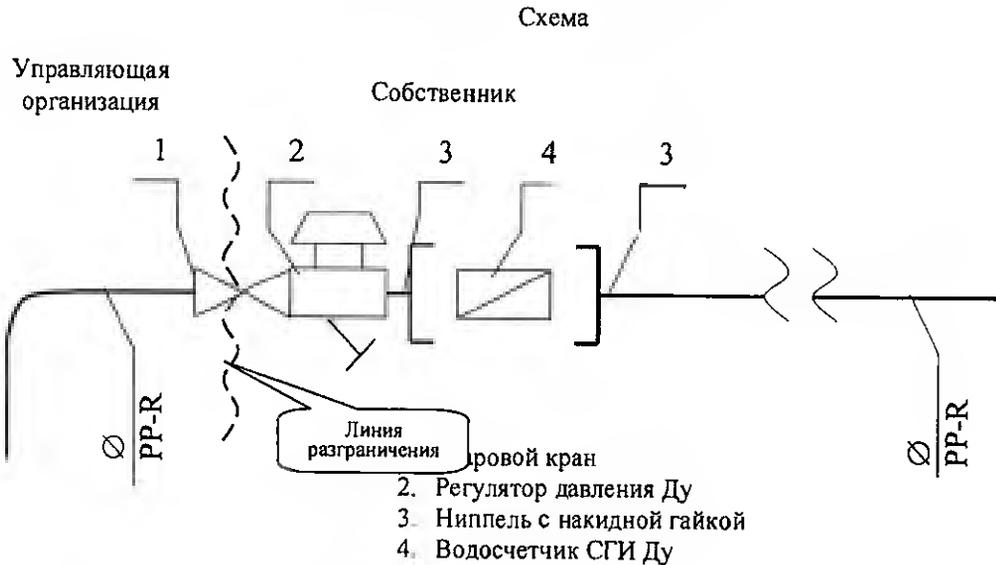
Исполнитель несет ответственность за надлежащее состояние и работоспособность систем горячего и холодного водоснабжения согласно нижеуказанной схеме до волнистой линии слева (включая шаровой кран).
