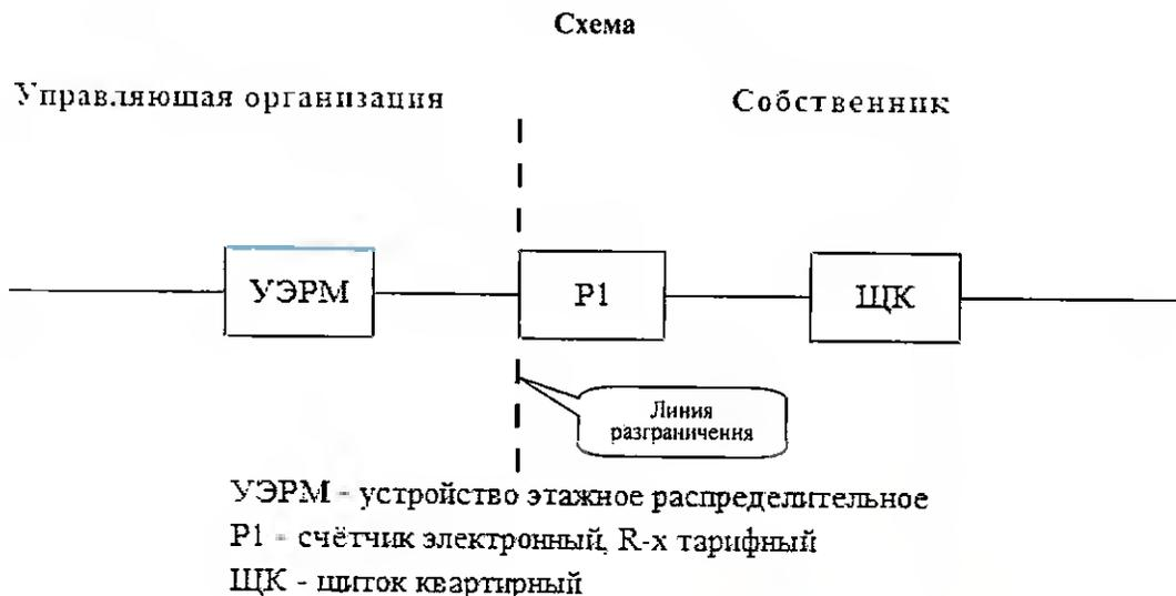
Исполнитель несет ответственность за надлежащее состояние и работоспособность питающих электрических сетей на квартиру согласно нижеуказанной схеме до прибора учета (пунктирной линии слева).
